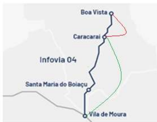
Figura 2 – Parte da Infovia 04 entre Vila do Moura (AM) a Boa Vista (RR)), com trechos subfluvial (enlaçado na cor verde) e terrestre (enlaçado na cor vermelha)
